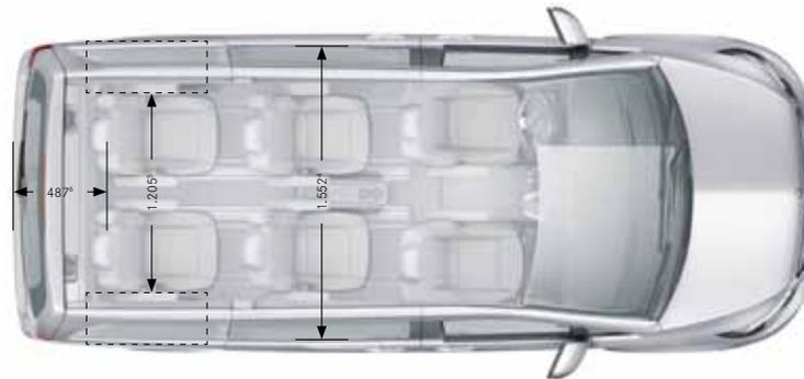
Todas las cotas en mm. Las dimensiones citadas son valores medios, válidos para vehículos con equipamiento básico y sin carga. <sup>1</sup> La altura del vehículo es 48 mm mayor con las barras longitudinales en el techo opcionales.
